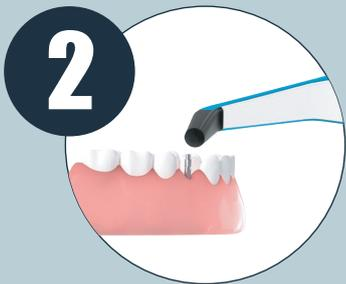
プローブから磁気を発し、共振周波数を測定します。
